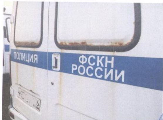
Фото 5. Следы коррозии кузова
