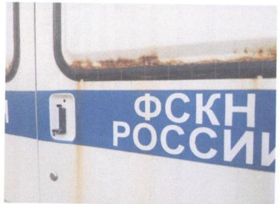
Фото 6. Следы коррозии кузова
